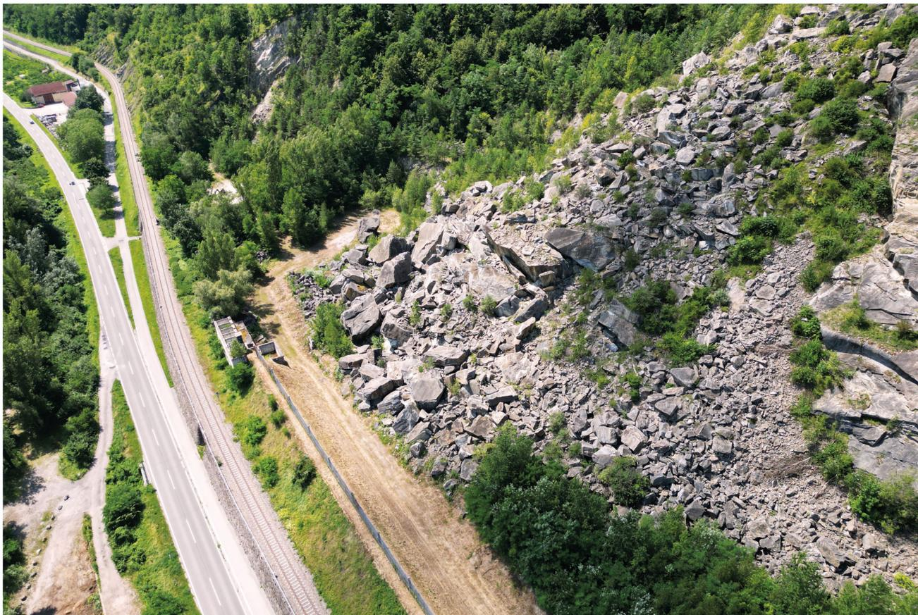
Infolge eines regenreichen Sommers kam es 2002 beim ehemaligen Spitzer Steinbruch zu einem Felssturz. 2004 wurde zum Schutz der Bahn ein 130 m langer Erddamm errichtet. Zusätzlich wurde auf der Dammkrone ein Fangzaun mit Warnsystem installiert (Laimer & Müllegger, 2012).
